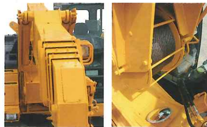
●フラットサーフェイスブーム ●ブーム下抱きウインチ、乱巻き防止用ミラー付
